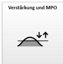
Wählen Sie mit dem Cursor die Verstärkungspegel aus, um sie einzustellen. Die Verstärkungspegel sind für leise (G40), mäßige (G60) und laute (G80) Klänge und Eingangsgeräusche einstellbar.
